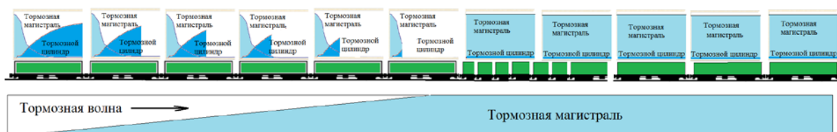
Рис. 1. Процесс распространения тормозной волны грузового поезда.
